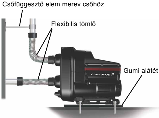
4. ábra A szivattyú zaj- és rezgéscsillapítása
